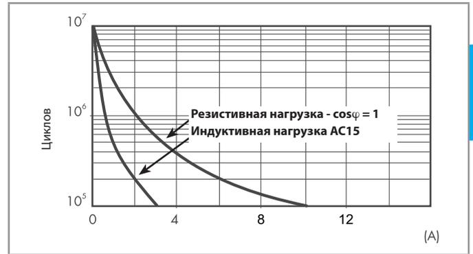
**F 48 - Электрическая долговечность (AC) при ном. нагрузке,**
