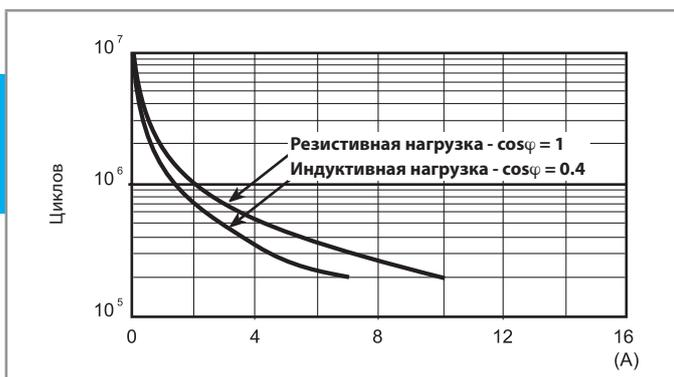
**F 58 - Электрическая долговечность (AC) при ном. нагрузке**
