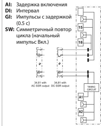
**Интерфейсные модули с электромеханическим реле, ширина 14 мм.**
