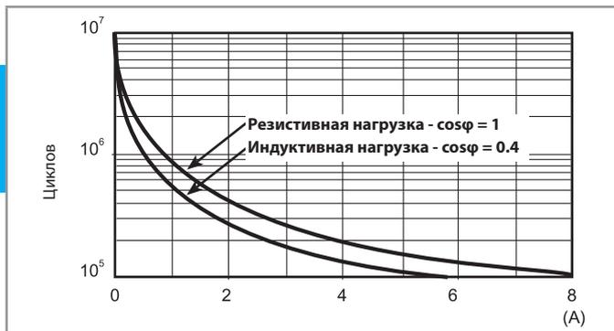
**F 4С - Электрическая долговечность (АС) при ном. нагрузке,**
